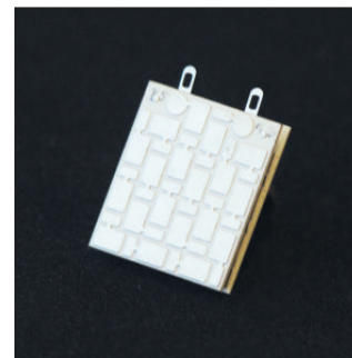
TEGnology har et samarbejde med BB Electronics i Horsens, der har fremstillet tre prototyper på termo-elektriske elementer. De fylder cirka halvdel af et kredittkort, og planen er at 50-80 elementer placeret ved udstødningen og integreret i en generator kan producere strøm nok til at forsyne en Volvo lastbil med al nødvendig strøm og dermed spares 10 procent af brændstoffet.
